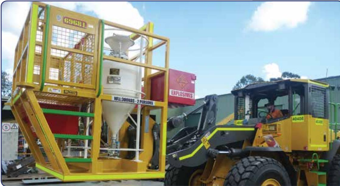
La plate-forme de travail souterrain pour ANFO est conçue pour fournir une surface de travail stable, robuste et sûre pour les applications souterraines. Cet équipement comprend deux récipients sous pression conçus pour le chargement souterrain de nitrate d'ammonium et gazole (ANFO), et est conçu conformément aux normes AS1418:10.
