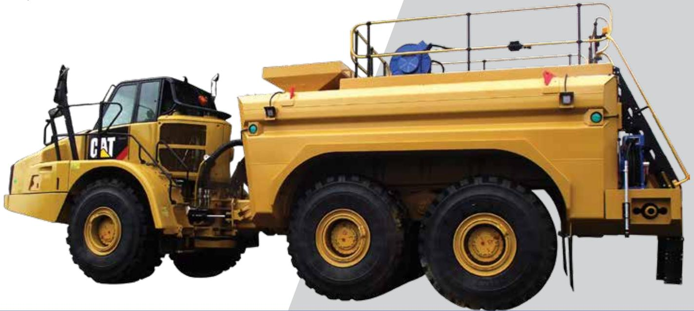
Ces machines offrent jusqu'à 16 mètres de couverture de pulvérisation routière et peuvent être équipées de fonctions de lavage de machine et/ou de lutte contre l'incendie
