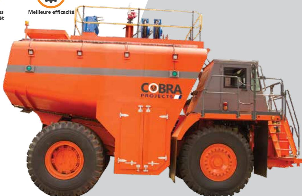
Pour préparer rapidement et efficacement la maintenance des grosses machines, Cobra a conçu des engins de lavage dédiés pour nettoyer simultanément les flèches, chenilles, plates-formes et zones de travail précises à l'aide de multiples sorties de lavage à haute pression et à fort volume.
