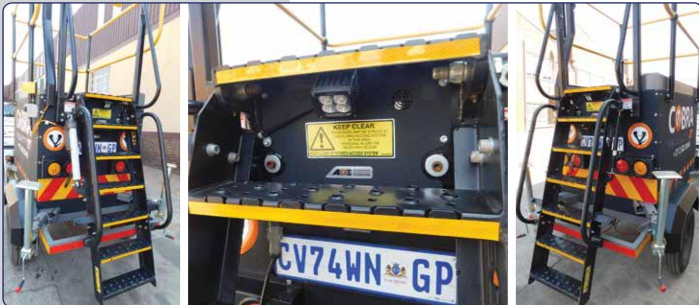
Le système d'accès électrique ADE est un escalier pouvant être monté sur la plupart des équipements miniers, de terrassement et ferroviaires. Ce système d'accès est conforme aux normes AS1657-2013 et AS3868-1991. Du fait qu'il n'exige aucune alimentation en énergie hydraulique pour son fonctionnement, ce système est une solution d'accès à prix très compétitif. Ce système peut se monter sur des équipements mobiles qui exigent une solution d'accès à escalier pliant motorisé.
