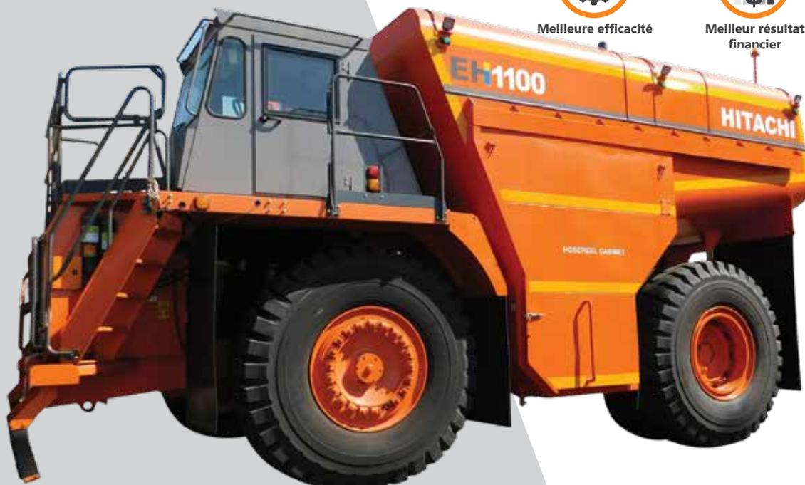
Pour réduire au minimum les temps d'intervention sur les très grosses machines, nous proposons de hauts débits de nombreux produits, du gazole à la graisse, sur un grand châssis RDT.
