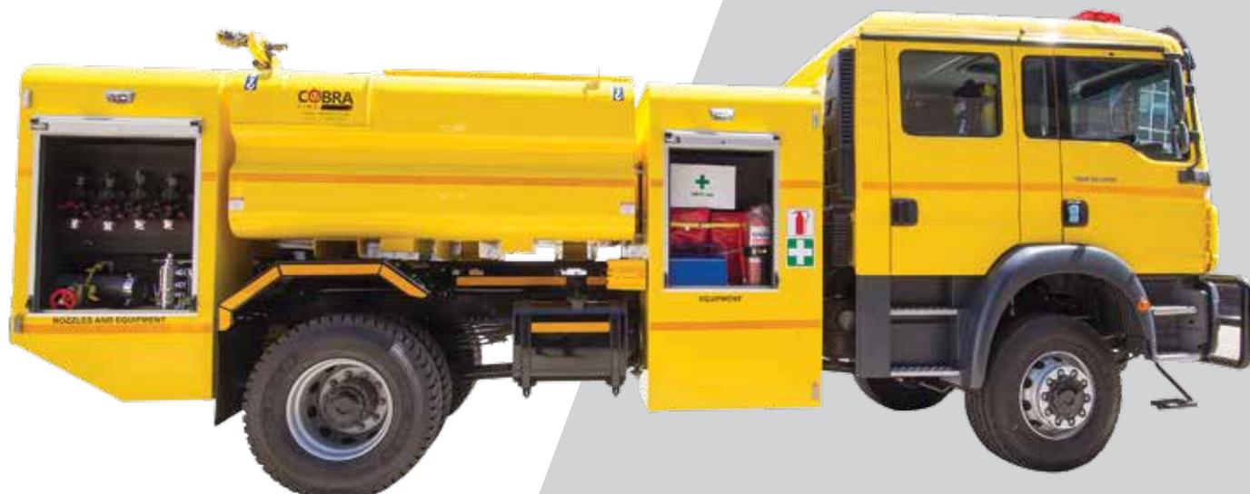
Motopompe de secours et d'incendie de catégorie moyenne-haute de style européen, montée sur un châssis 4x2 ou 4x4 du commerce, cabine simple ou double, conçue spécifiquement pour l'environnement minier.
