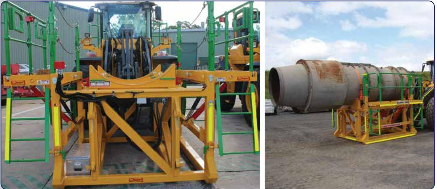
La plate-forme de service ventilateur et silencieux dynamique QMW est conçue pour fournir une plate-forme stable, robuste et sûre pour les applications souterraines, conformes aux normes AS1418.10, EN280:2001 et MEWP.
