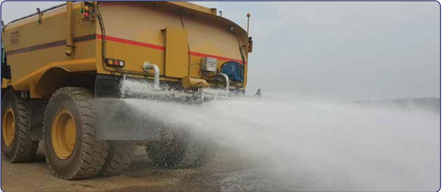
Ces machines offrent jusqu'à 16 mètres de couverture de pulvérisation routière et peuvent être équipées de fonctions de lavage de machine et/ou de lutte contre l'incendie
