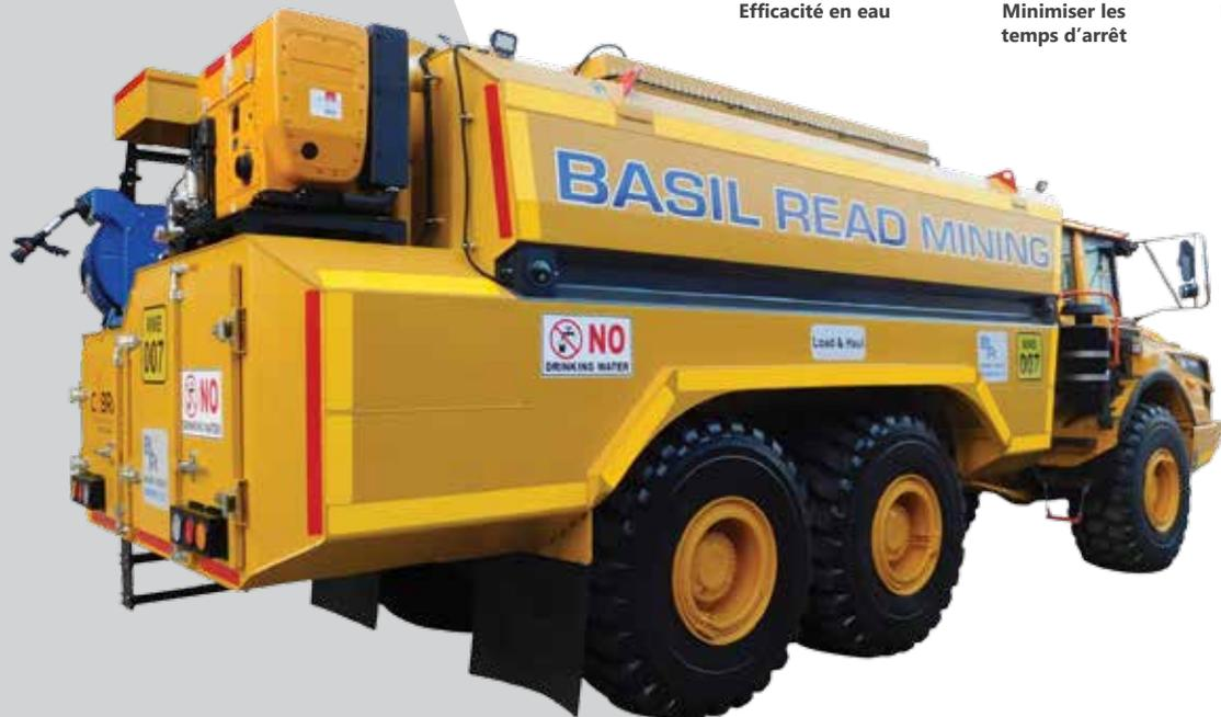
Pour préparer rapidement et efficacement la maintenance des grosses machines, Cobra a conçu des engins de lavage dédiés pour nettoyer simultanément les flèches, chenilles, plates-formes et zones de travail précises à l'aide de multiples sorties de lavage à haute pression et à fort volume.
