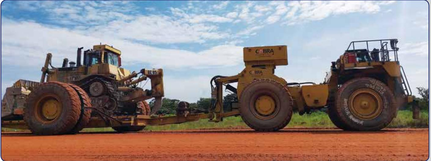
Cette plate-forme surbaissée basculante de 120 tonnes se charge par l'arrière, elle est conçue spécifiquement pour permettre le chargement/déchargement et l'utilisation par une personne seule, pour faciliter le repositionnement à courte distance des équipements à chenilles.
